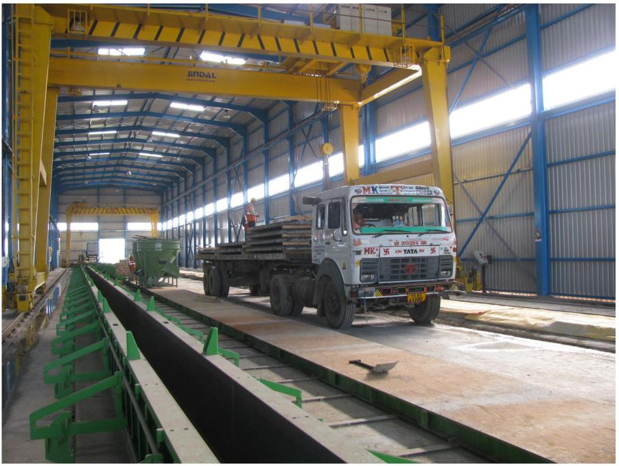
BED FOR BEAM & SLAB CASTING
